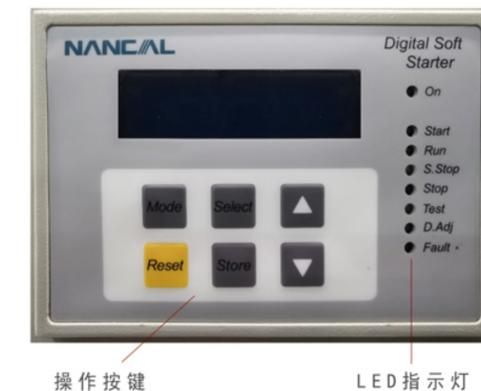
显示软启动、运行、软停车、停止、双调节、故障等状态;
