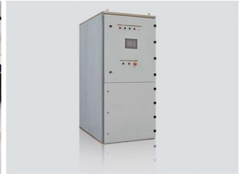
NC3S 系列高压固态软起动器是基于数字微处理器 (DSP) 控制技术和现代电力电子控制技术而设计的新型高科技电气设备,是为高压大型电机提供软起动的专用设备,可为电机提供较佳的降压限流式软起动方式,为适应不同的负载条件,达到更好的起动效果,NC3S 设计了多种控制功能,从而实现以起动电机所需要的较小电流来平稳加速起动,因此有效的减少了起动时的电网压降,减弱起动时的电流冲击和机械振动,在需要软停时能向电机提供平缓渐减的控制电压,将电机传动平稳停车。
