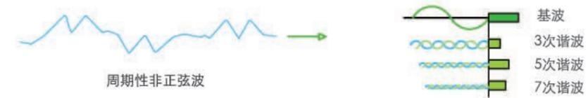
如今广泛使用的负载大部分是非线性的，如整流器、变压器、UPS、电梯、空调、荧光灯、复印机、家用电器等，这些非线性负载会产生大量的谐波电流并注入到电网中，是电网电压产生畸变，这种谐波污染会对电网和用户产生严重的危害。
